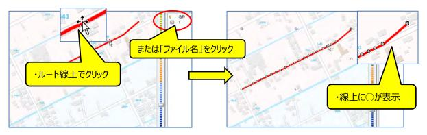
⑤ 修正したいポイントをクリックするとマウスが ๋ に変わり、 ๋ の状態のままで移動させると、ポイントが 修正できます。 \_\_\_\_\_\_\_
